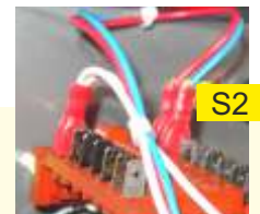
S2 - Wahlschalter Melken/Reinigen (Kabel rot/blau/weiß)
