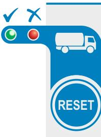
Die Funktion „Tankwächter“ signalisiert, ob die Milchqualität gewährleistet ist oder ob ein Fehler bei der Reinigung bzw. Kühlung aufgetreten ist.
