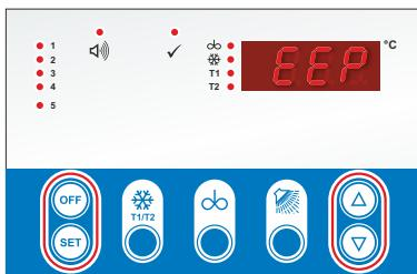
Beim Einschalten der Steuerung prüft diese, ob die Parameterwerte im EE-prom-Speicher unzulässig verändert wurden. (Dies ist in seltenen Fällen möglich, z.B. durch EMV-Einwirkung oder durch Blitzschlag etc.) Wurde eine unzulässige Veränderung festgestellt, wird „EEP“ im Display angezeigt - die Steuerung ist nicht betriebsbereit.
