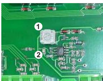
Die Niveausteuerung ist werkseitig auf 'mittlere' Wasserqualität voreingestellt. Je nach Härtegrad im örtlichen Wassernetz kann die Empfindlichkeit über ein Potentiometer wie folgt verstellt werden:
